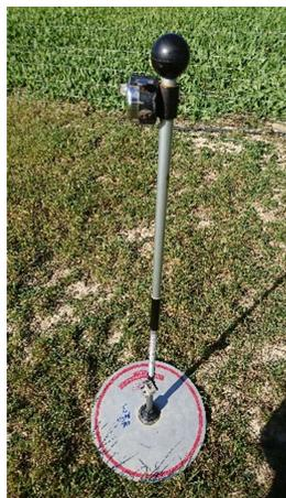
り牧草地に立つ。測定方法は2歩進むごとに1回、プレートメーターを垂直に牧草地に押し付ける。（写真2、3）プレートメーターは草を押しつぶしながらもそれ以上押しつぶせない高さで止まる。しかしプレートメーターを貫く軸は草をかき分けそのまま地面に到達するが、その際 0.5cm 間隔に刻まれた軸の目盛りに備え付けられたカウンターがその分だけ回転し、その押しつぶされた草の高さ（Compressed pasture height）をカウントする。パドックを斜めに横切るように進みながらそれを 50 回繰り返す。50 回計測したところでカウンターの数値を記録する。スタートの数値は予め記録しておく。次のパドックに移動する際は数値が動かないようにカウンターを指で固定し、次の
