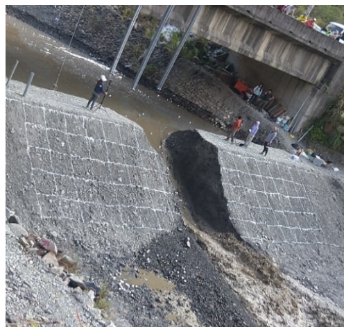
図-8 実験林場での破堤実験の様子
